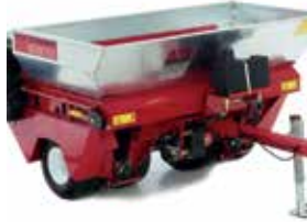
Toro Topdresser 2500 %30 artırılabilir 900 lt hazne kapasitesi 152 cm serpm genişliği 930 kg taşıma kapasitesi 659 kg ağırlık Traktör arkası çeki sistemi
